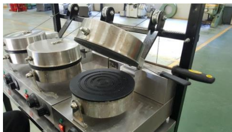
ภาพที่ 5 ขุดกลไกการเปิดฝาเตาโดยการใช้เท้าเหยียบ
