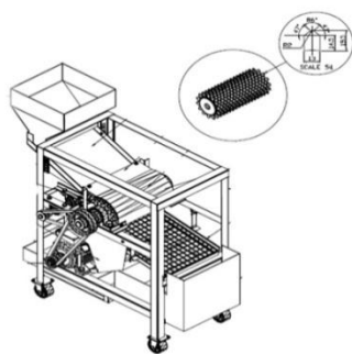
รูปที่ 1 ระบบการทำงานของเครื่องกะเทาะมะขาม
