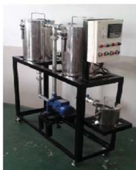
ภาพที่ 1 โครงสร้างหลักของเครื่องผลิตไบโอดีเซลจากสบู่ดำและน้ำมันพืชที่ใช้แล้ว
