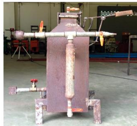
รูปที่ 2 โครงสร้างหลักของเตาแก๊สซีฟิเออร์ที่ติดตั้งร่วมกับชุดกระทุ้งถ่าน
